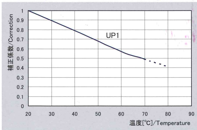
ジュンロン UP1 チューブの温度別破壊圧力補正係数グラフ Graph of burst pressure correction coefficient of Junron UP1 by temperature
